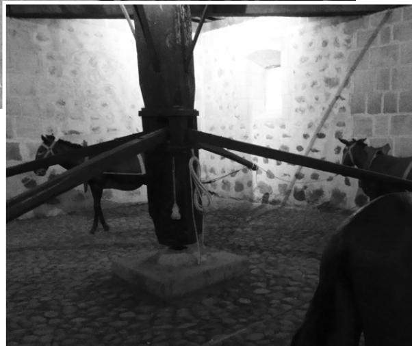
Raderwerk van de Moneda in Potosí Raderwerk aangedreven door lastdieren.
